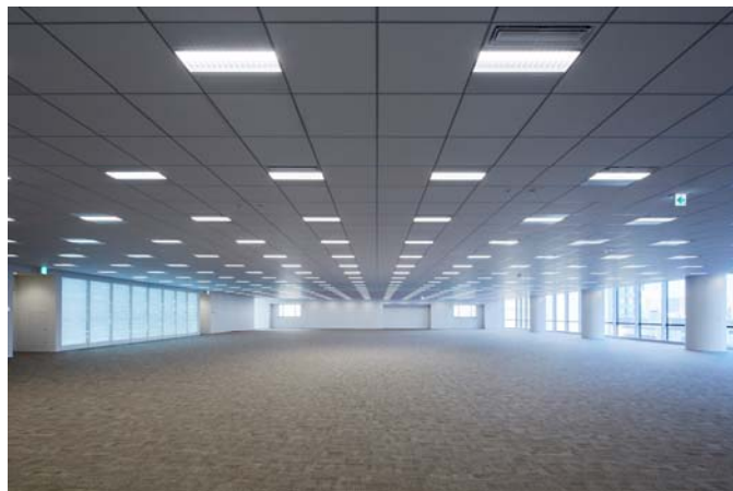
基準階オフィスには光ダクト（写真左側）により 4面採光の実現
